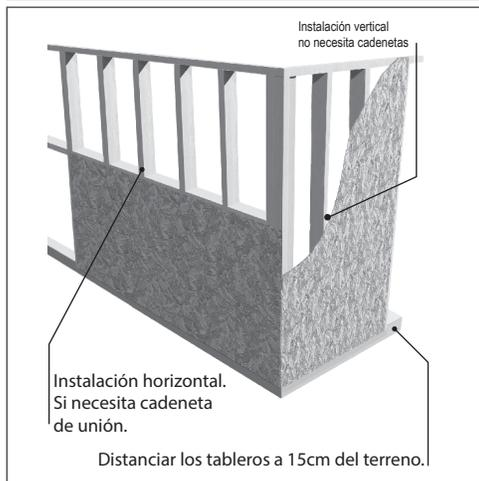
Al momento de fijar el tablero a la estructura de piso, párese sobre el eje de las vigas, con esto evitará que los tableros queden tensionados en la instalación.
